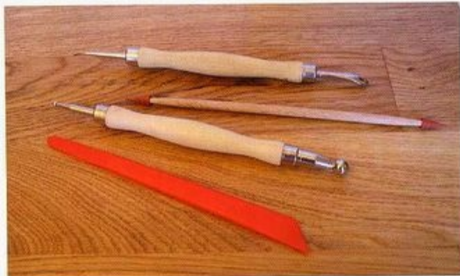
Outils de modelage : ébauchoirs de diverses formes.
